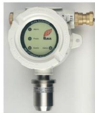
Alpa Sigma-smart toxsurvey Robuust epoxy gelakte aluminium behuizing met RVS meeikop 4-20mA
